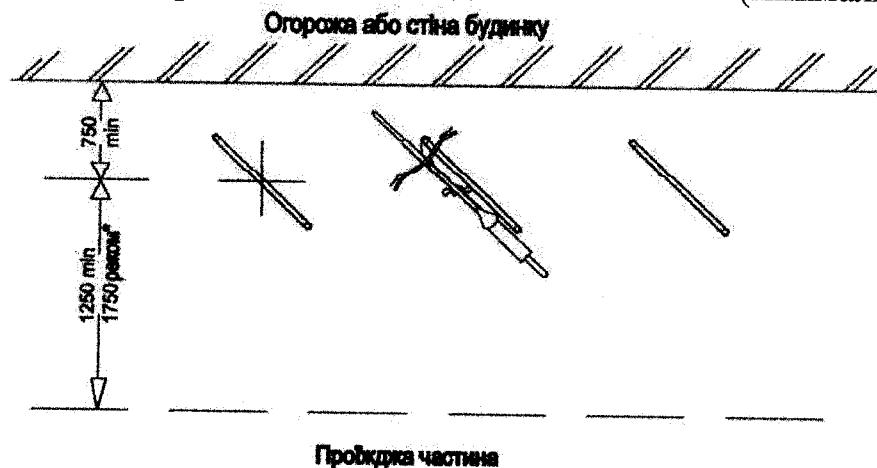
Рис. 5.4. Велопарковки, що розташовуються під кутом 45^\circ до огорож, меж будинків та проїзної частини.
