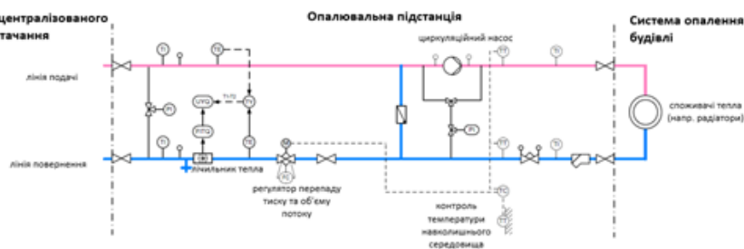
Малюнок 8: Схема підстанції з прямим підігрівом (Джерело: Wien Energie)
