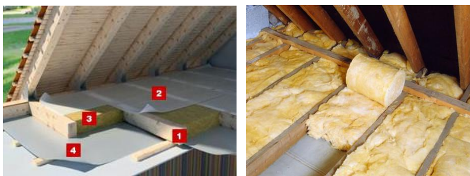
Структура шарів: 1) паронепроникний шар, 2) додаткова дифузійна мембрана, 3) мінеральна вата, 4) парова плівка
